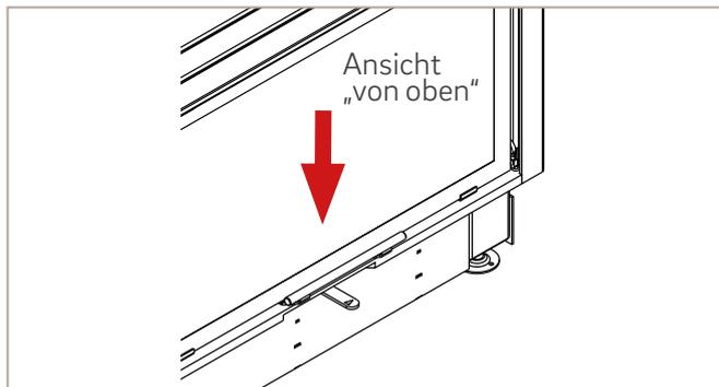
Abb. 20: Verstellhebel „Zuluft“
