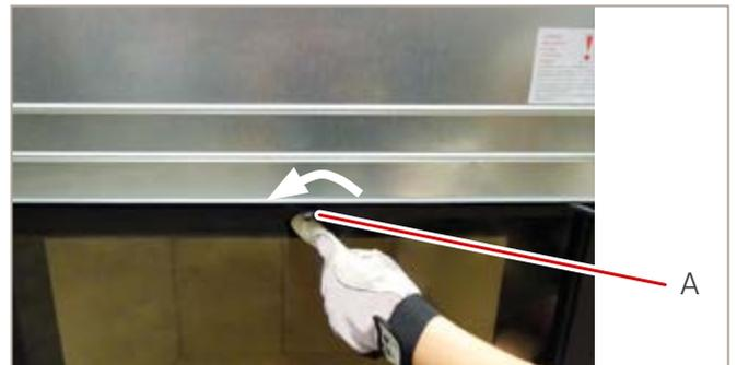
Abb. 29: Verriegelung geöffnet
