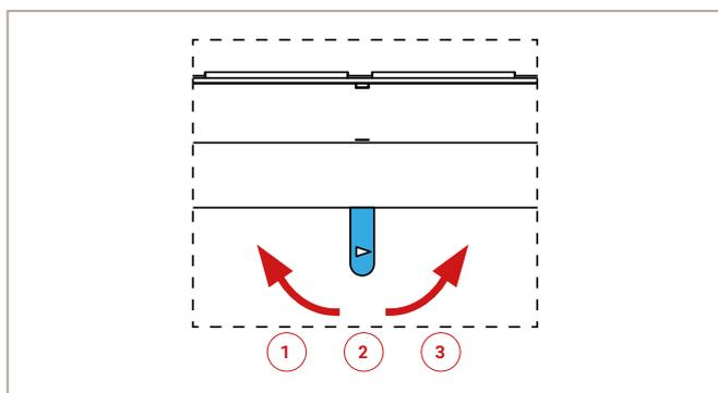
Abb. 21: Verstellhebel „Zuluft“ – Positionen für Lina, Lina TV
