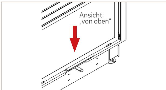
Abb. 19: Verstellhebel „Zuluft“
