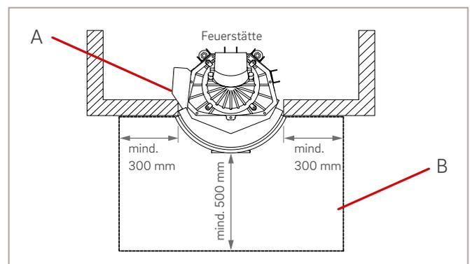
Abb. 3: Fußbodenschutz im Bereich vor der Feuerraumöffnung, Ronda
