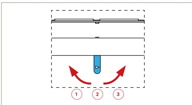
Abb. 20: Verstellhebel „Zuluft“ – Positionen für Ronda, Pano
